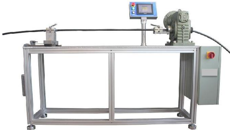
Figura 10. Máquina de torsión, "IEC 60794-1-21 optical fiber cables – basic optical cable test procedures. Method 7 – torsion". Laboratorio de Pruebas Mecánicas, FIBERLAB S. DE R.L. DE C.V.
