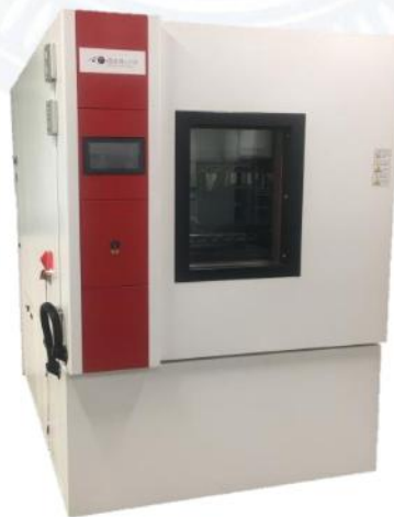
Figura 14. Cámara de envejecimiento térmico, norma internacional “IEC 60794-1-22 optical fiber cables – basic optical cable test procedures. Method F9 – aging”. Laboratorio de Pruebas Ambientales, FIBERLAB S. DE R.L. DE C.V.
