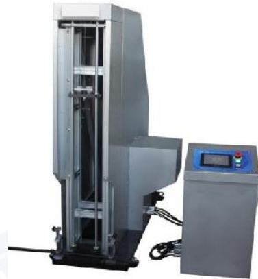
Figura 6. Máquina de impacto, norma internacional “IEC 60794-1-21 optical fiber cables – basic optical cable test procedures. Method E4 – Impact”. Laboratorio de Pruebas Mecánicas. FIBERLAB S. DE R.L. DE C.V.
