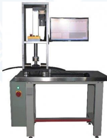
Figura 4. Máquina de compresión, norma internacional “IEC 60794-1-21 optical fiber cables – basic optical cable test procedures. Method E3 – Crush”. Laboratorio de Pruebas Mecánicas, FIBERLAB S. DE R.L. DE C.V.
