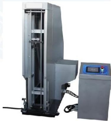
Figura 8. Máquina de impacto, norma internacional "IEC 60794-1-21 optical fiber cables – basic optical cable test procedures. Method E4 – Impact". Laboratorio de Pruebas Mecánicas. FIBERLAB S. DE R.L. DE C.V.
