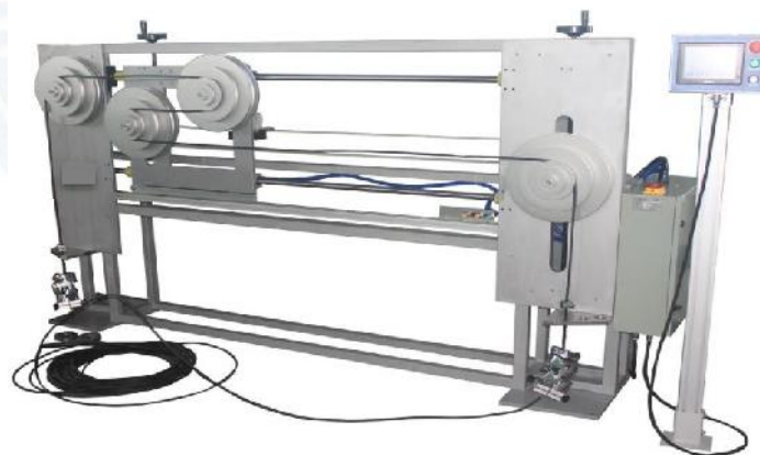
Figura 14. Máquina de flexión, norma internacional "IEC 60794-1-21 optical fiber cables – basic optical cable test procedures. Method 8 – Flexions". Laboratorio de Pruebas Mecánicas, FIBERLAB S. DE R.L. DE C.V
