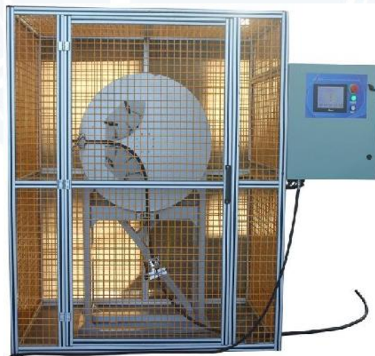
Figura 10. Máquina de dobleces repetidos, norma internacional "IEC 60794-1-21 optical fiber cables – basic optical cable test procedures. Method E6 – repeated bending". Laboratorio de Pruebas Mecánicas. FIBERLAB S. DE R.L. DE C.V.
