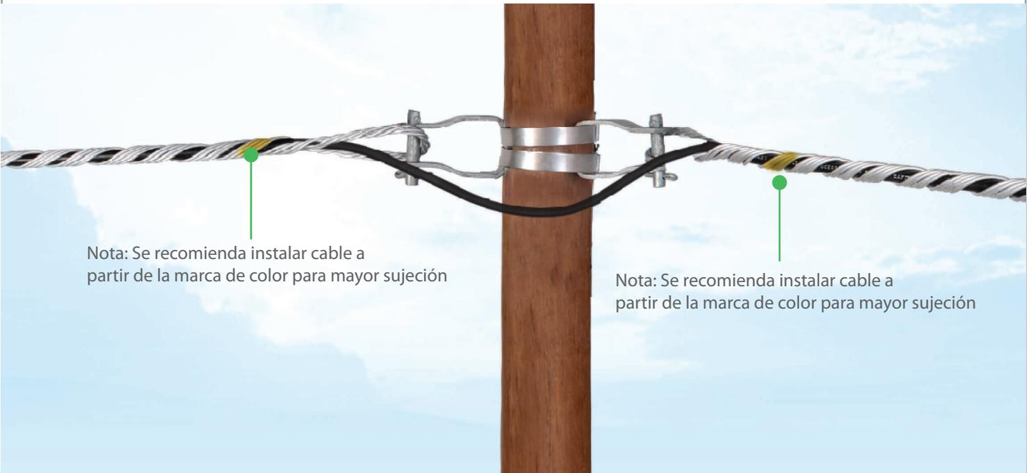
Nota: Se recomienda instalar cable a partir de la marca de color para mayor sujeción
